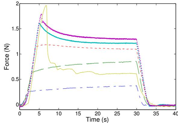
**Figure 4-7: Actuator Blocking Force Measurements versus Voltage** (---) 200V (- - -) 300V (...) 400V (\* \* \*) 500V (x) 600V (-) 700V
