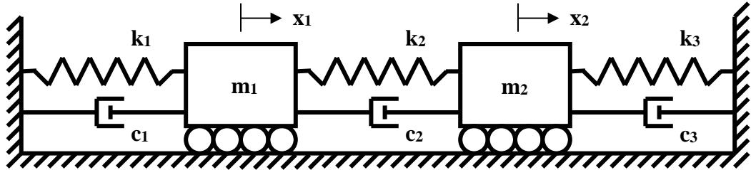
$$m_1 \ddot{x}_1 = -k_1 x_1 - c_1 \dot{x}_1 - k_2(x_1 - x_2) - c_2(\dot{x}_1 - \dot{x}_2)$$
